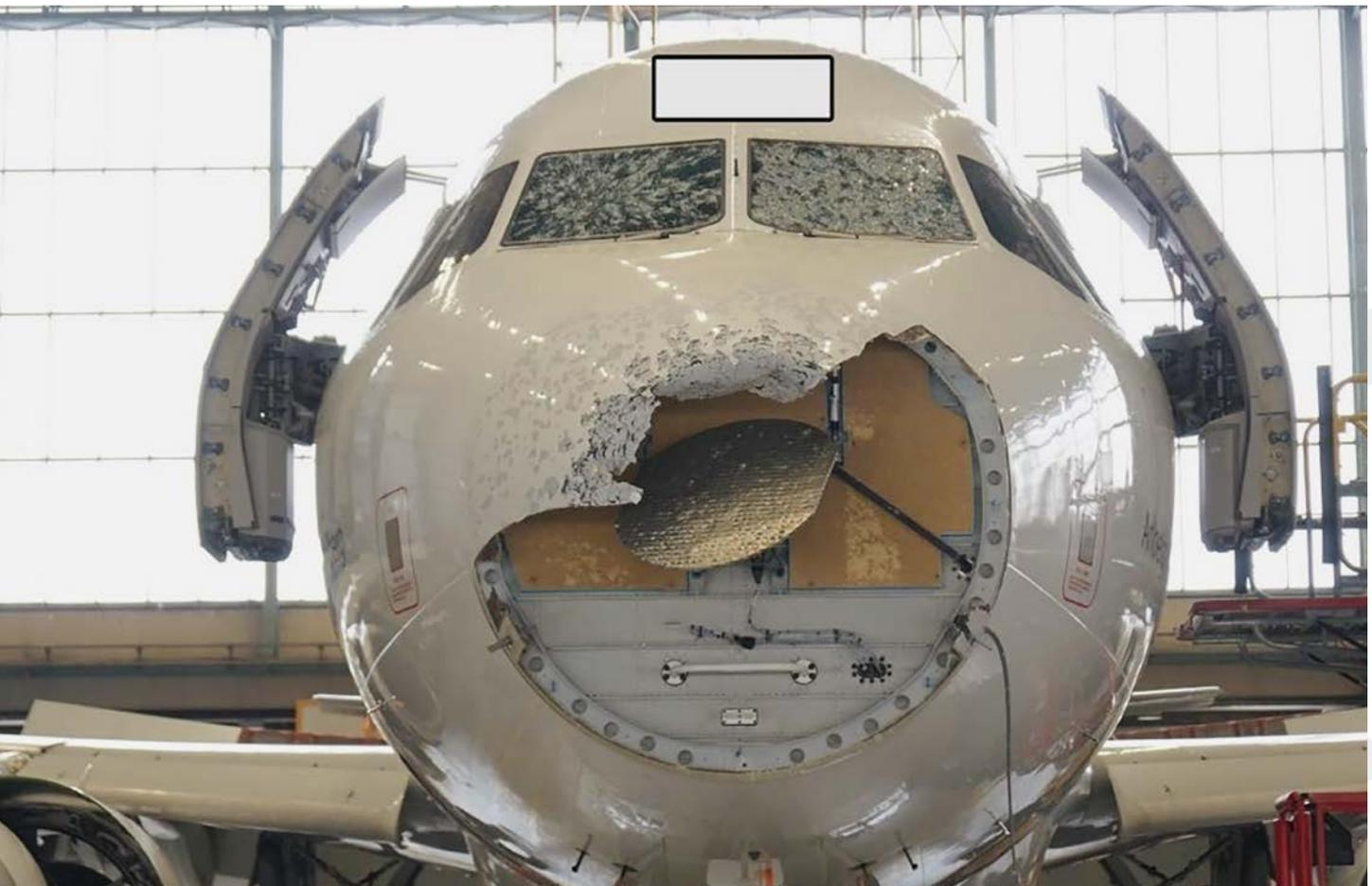
→ Hagelschäden an Nase/Radom und Windschutzscheibe. Quelle: SUB
