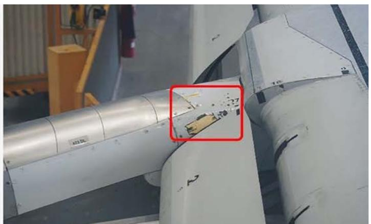
→ Schäden an Verkleidungen der linken und rechten Triebwerksaufhängung (Pylon). Quelle: SUB
