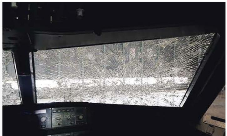
→ Schäden an linker (CM1) und rechter (CM2) Windschutzscheibe – Cockpitsicht. Quelle: SUB
